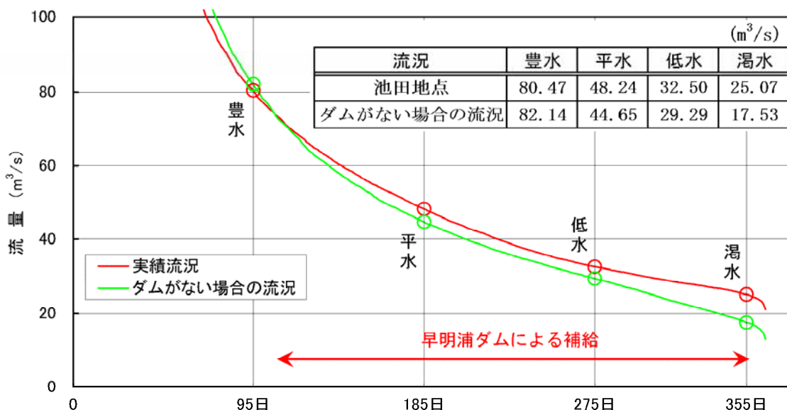
図 - 2.2.4 早明浦ダムによる流況の安定化（池田ダム流入地点）
