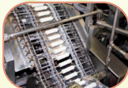
昔の手作りとは違って、自動で製造されている竹ちくわ。まず、竹にすり身を巻き付け、焼き機へと送られます。
