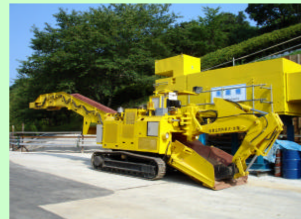
トンネルを掘削する機械 (ジャブローダー)
