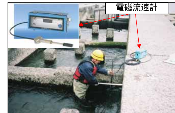
電磁流速計による流速測定状況
