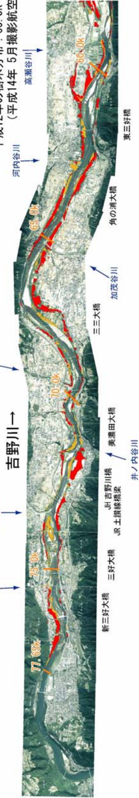
図 1.3.7 河道内樹木の平面分布の変遷 (昭和50年と平成12年比較) : 岩津 (40.0k) ~ 池田 (77.7k)
