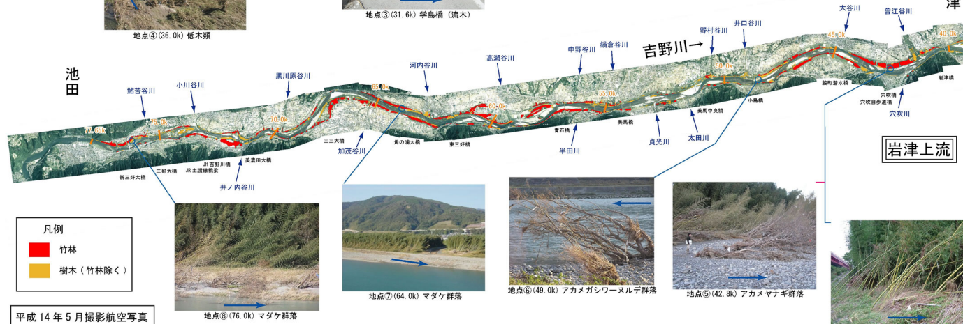
図 2.3.12 台風 23 号（平成 16 年 10 月洪水）後の樹木倒伏状況
