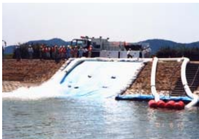
排水ポンプ車による排水状況（訓練）
