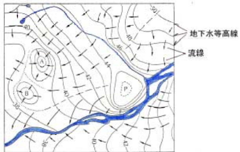
図-6.2.8 地下水の流線を表す図 「出典：地下水調査法，山本荘毅；古今書院」
