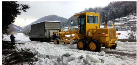
除雪車両による立ち往生車両の移動 (牽引による移動)
