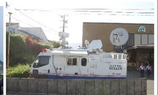
南阿蘇村にて通信支援を行う「衛星通信車」
