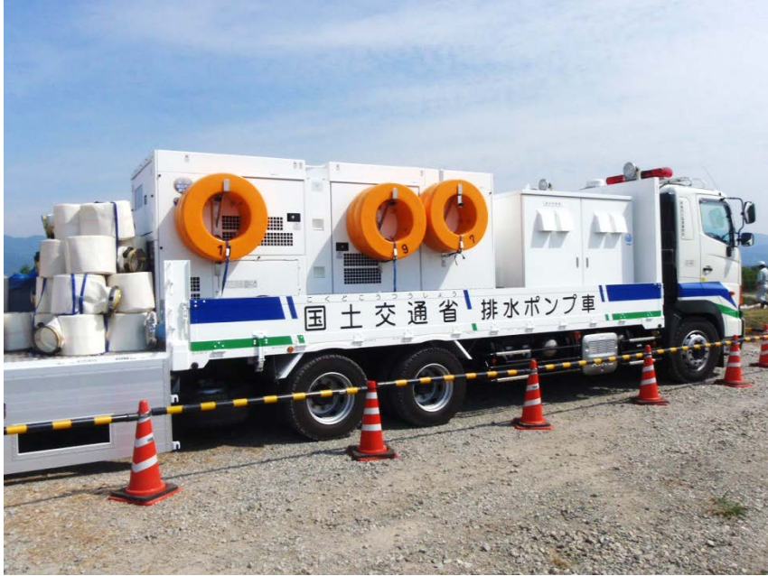
排水ポンプ車
