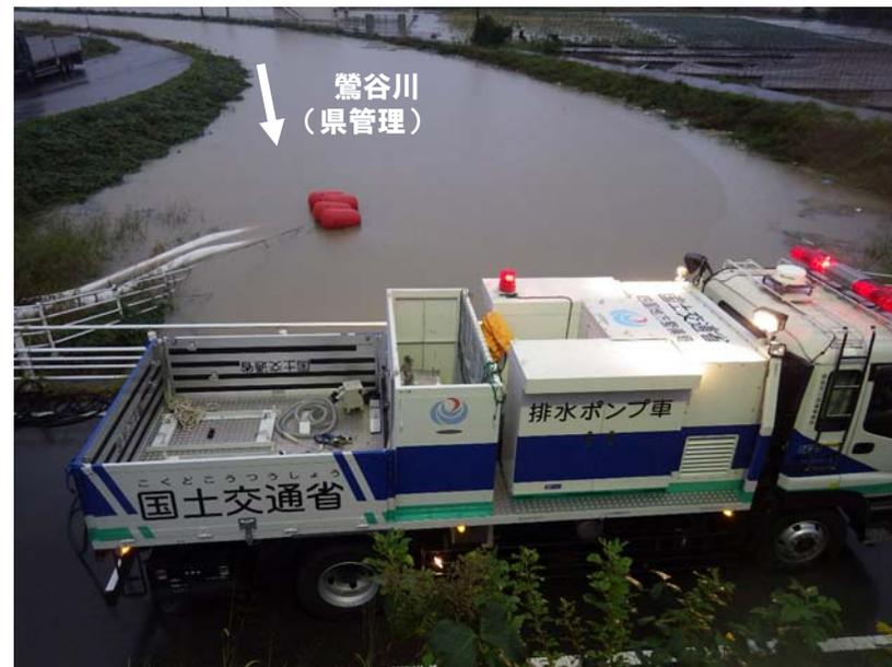
排水ポンプ車の稼働により約5時間で1万6千m<sup>3</sup>程度(25mプール約38杯分)を排水した。
