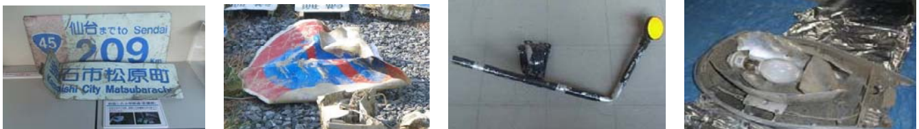
小型標識「距離標」 規制標識「駐車禁止」 視線誘導標 道路照明灯(灯具)
