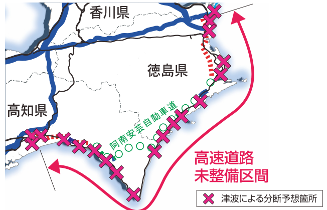
▲東南海・南海地震発生時の道路寸断箇所(想定)
