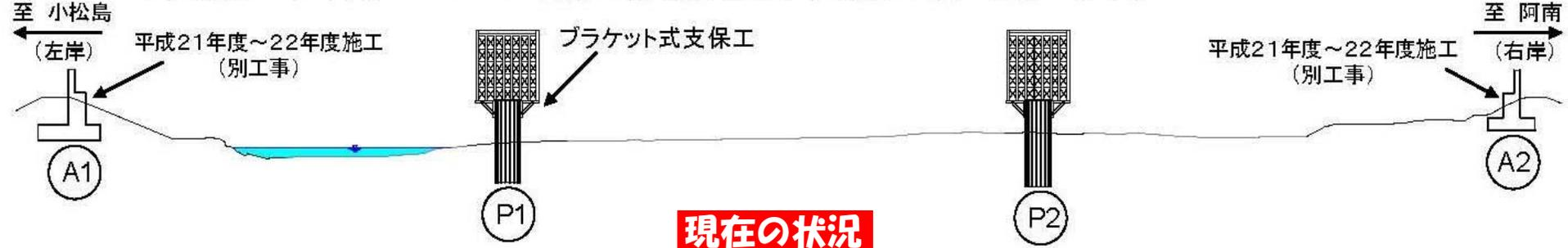
②P1・P2の張出し架設工(8ヶ月) - 移動作業車により、P1・P2橋脚から外側に向かって張出し架設を行います。
