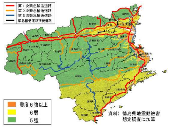
南海・東南海地震による震度分布予測図と緊急輸送道路
