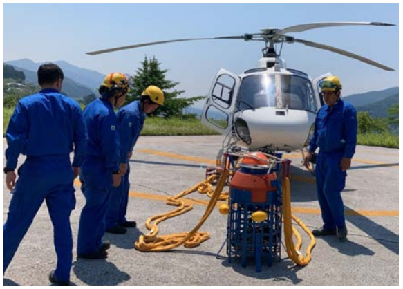
写真-1 投下型水位計吊り込みの様子
