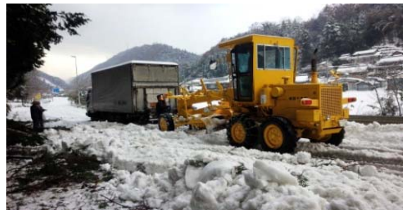
除雪車両による立ち往生車両の移動 (牽引による移動)
