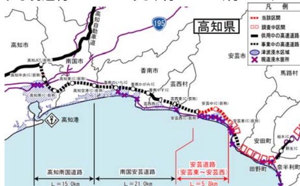
図2 津波浸水による分断箇所
