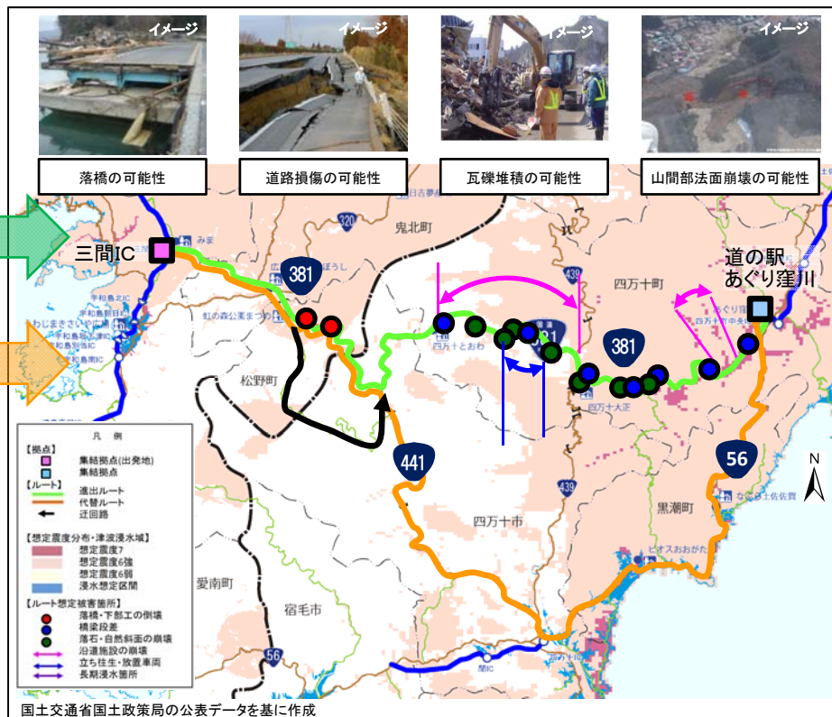
図 広域道路啓開のための「進出ルート」(ルート⑤:宇和島～四万十町)
