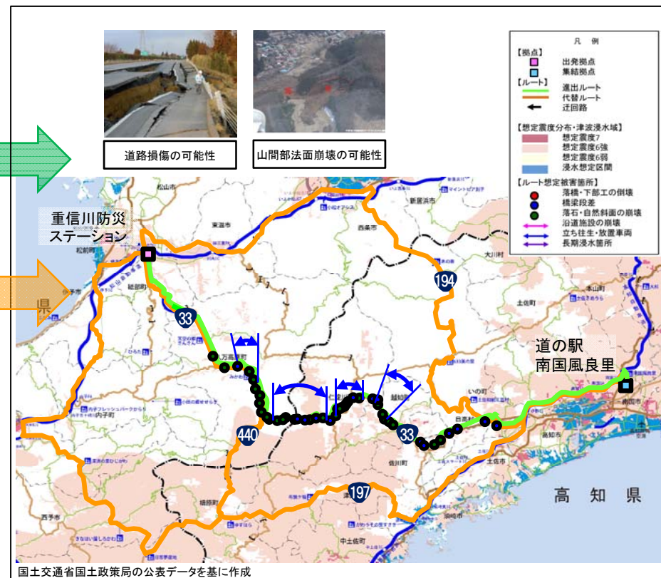
図 広域道路啓開のための「進出ルート」(ルート③:松山～高知) (写真)東日本大震災の記録-国土交通省の災害対応(国土交通省)
