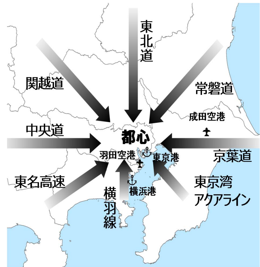
図 首都直下地震に備えた“八方向作戦”による道路啓開
