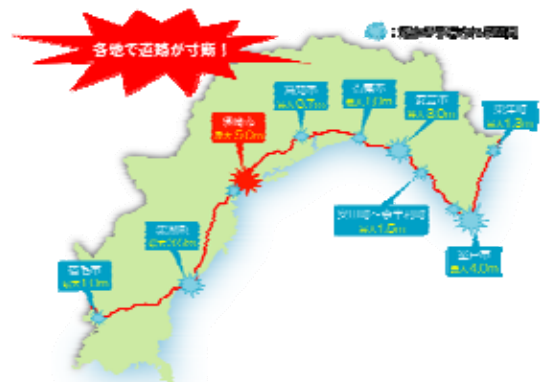
図 - 13 南海地震発生時の津波による現道の冠水予想区間
