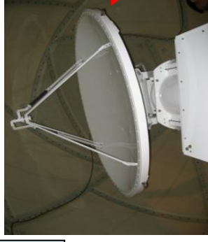
XバンドMPLレーダ雨量計 (アンテナ直径:約2m)
