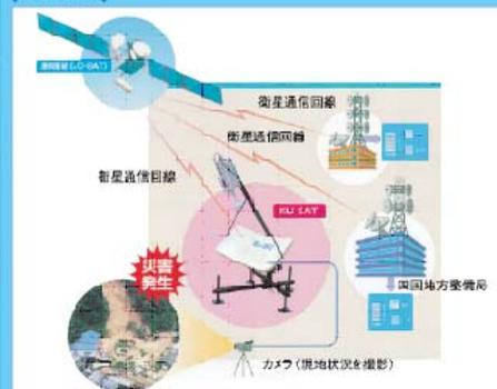
**機械概要** 衛星経由により、カメラ画像を送る可搬式の装置
