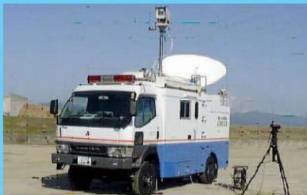
**機械概要** 衛星経由により、映像を送る装置を搭載した車両
