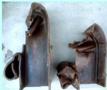
鉛のように変形した支保工(H形鋼)
