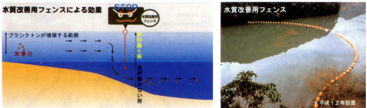
図 2.2.7 プランクトンの大量発生を防ぐための水質改善用フェンスの設置（野村ダム）
