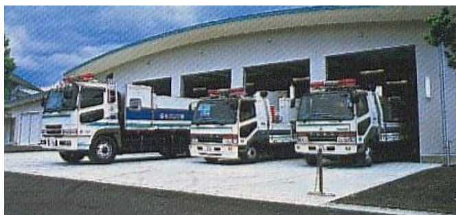
図 2.1.4(2) 排水ポンプ車
