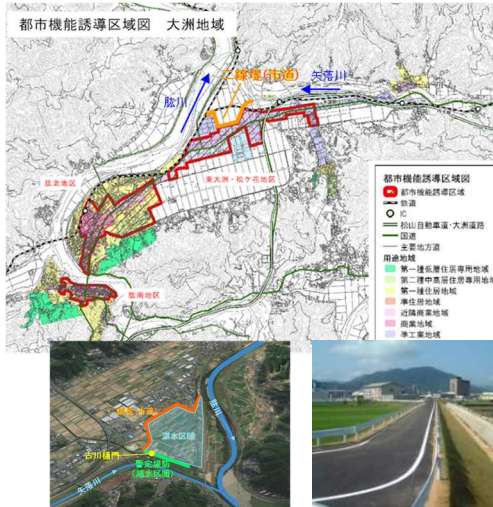
大洲市による 二線堤の整備
