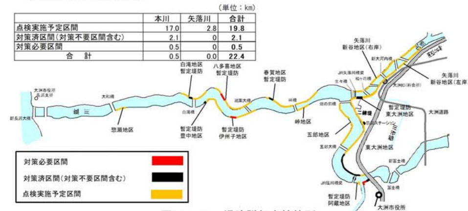
図 4.2.12 堤防詳細点検箇所
