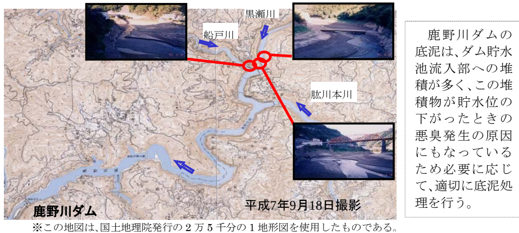
図 4.3.9 鹿野川ダム流入部の底泥堆積状況
