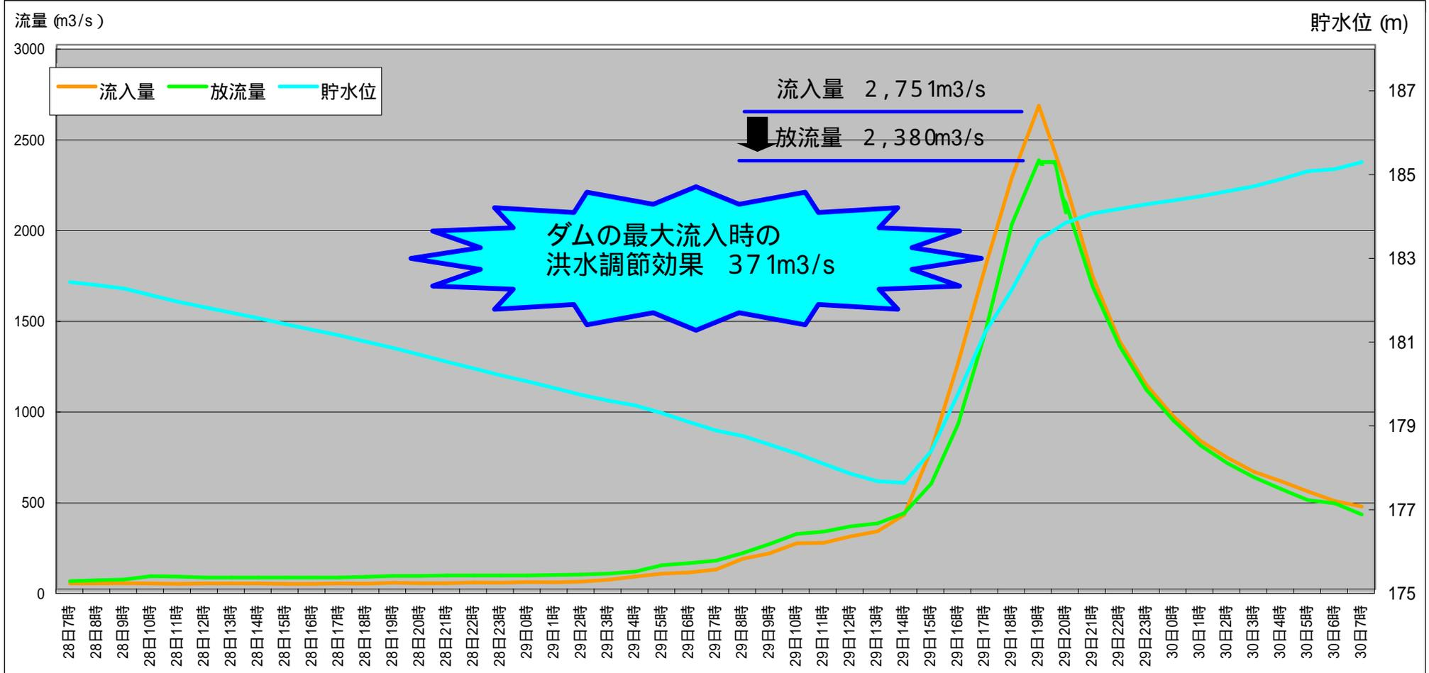
水位低下により洪水調節に必要な容量を確保
