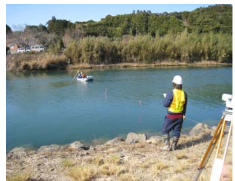
写真4.2.3 河川縦横断測量状況
