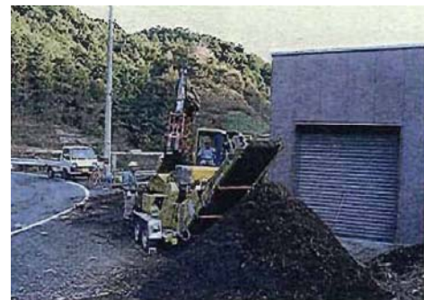
炭にならないような小さな木くずは、チップにして、カブト虫の寝床などに利用する。
