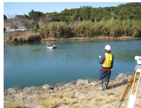
写真4.2.3 河川縦横断測量状況
