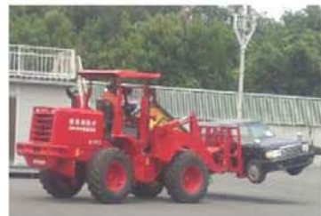
車両移動のための具体的方策 (例:ホイールローダーによる移動)
