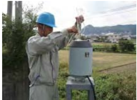
水文観測所の点検（雨量）
