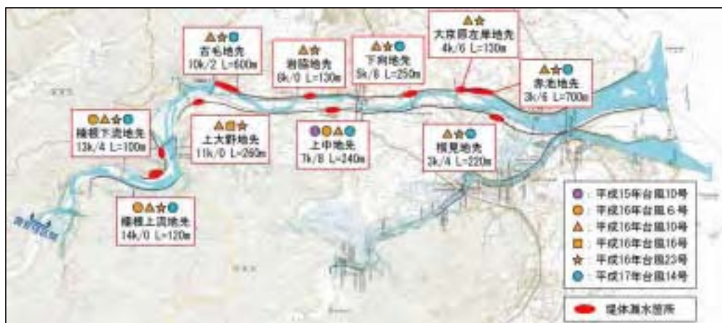
図 - 2.1.15 漏水発生位置図 (平成15~17年)
