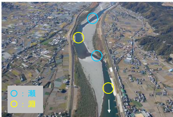
瀬・淵の連続性（北岸堰下流）
