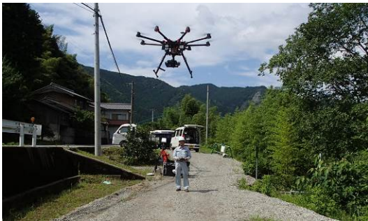
ドローンによる 3 次元測量
