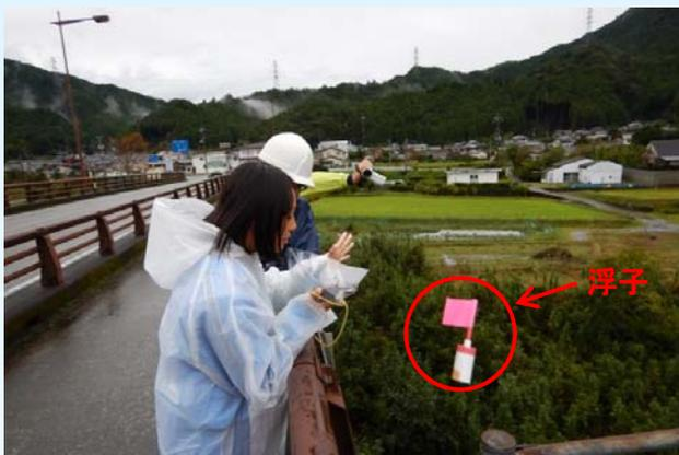
川の流れの速さを本番とおりに浮子(ふし)を使って観測しました。橋の上から浮子を投下します。
