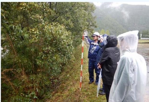
浮子が川の決められた区間を流れ下るのにかかった時間を測って、川の流れの速さを観測します。
