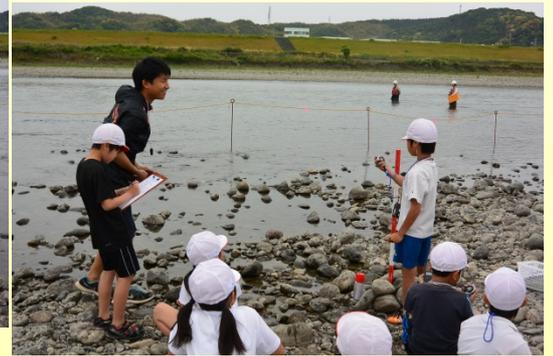
浮子による流量観測の流速測定を体験。20mの区間で浮子が流れる時間を計測。河岸からおよそ10m（河岸近く）、15m、20m（川の中心近く）の3測線で測定。
