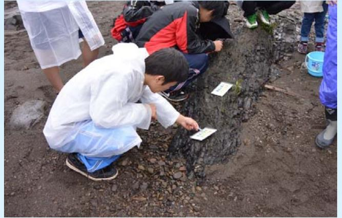
次に那賀川の丹生谷橋周辺で野外実習。最初は簡易検査キットを使った水質調査。那賀川の水のpHとCODを測定しました。
