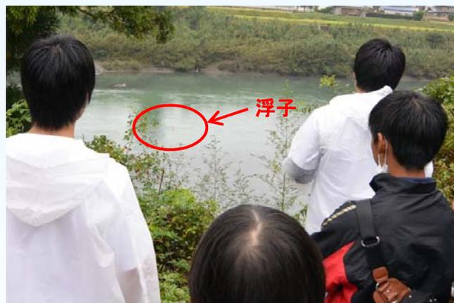
橋の上から投下した浮子が、川の決められた区間を流れ下るのにかかった時間を測って、川の流れの速さを観測します。
