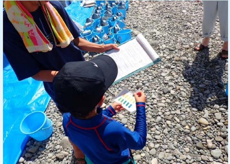
試薬の入ったチューブで水を吸い、色の変化から水質を測ります。
