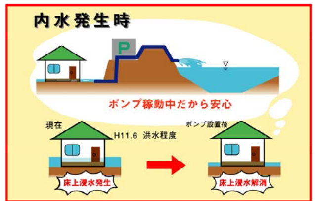
2基の排水ポンプ場の設置
