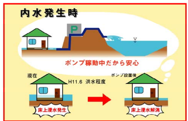
2基の排水ポンプ場の設置
