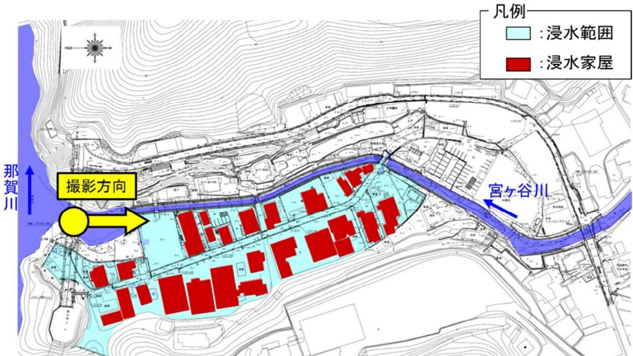
図 6.4 平成 21 年 8 月洪水による平谷地区の浸水区域
