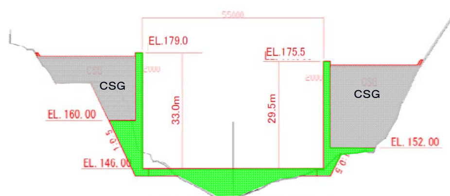
壁背面にCSGを採用した壁構造
