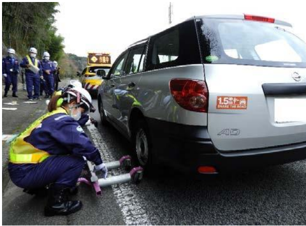
車両簡易移動器具による放置車両の移動
