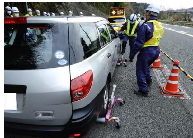
車両簡易移動器具による放置車両の移動
