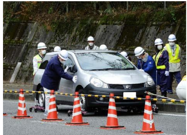
車両簡易移動器具による放置車両の移動
