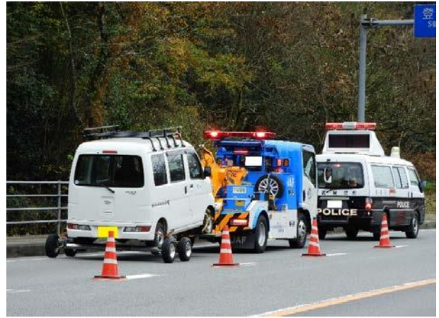
車両簡易移動器具の設置
