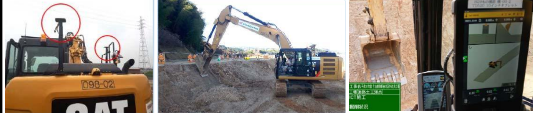
バックホウに設置しているGNSS受信アンテナ（2軸）
