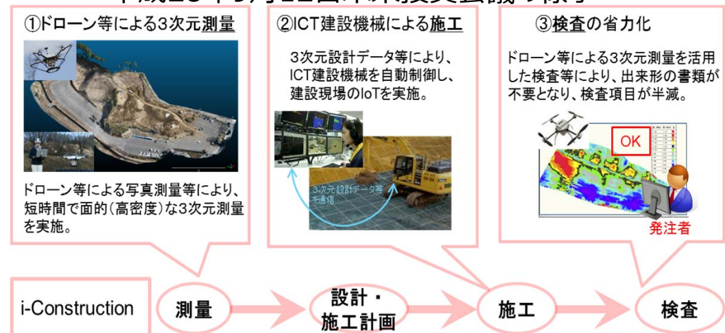
ICTの土工への活用イメージ (ICT土工)
